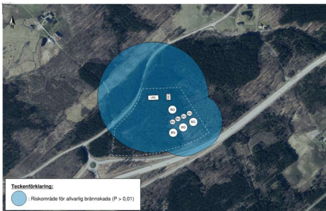
Figur 47. Riskområde för allvarlig brännskada.
