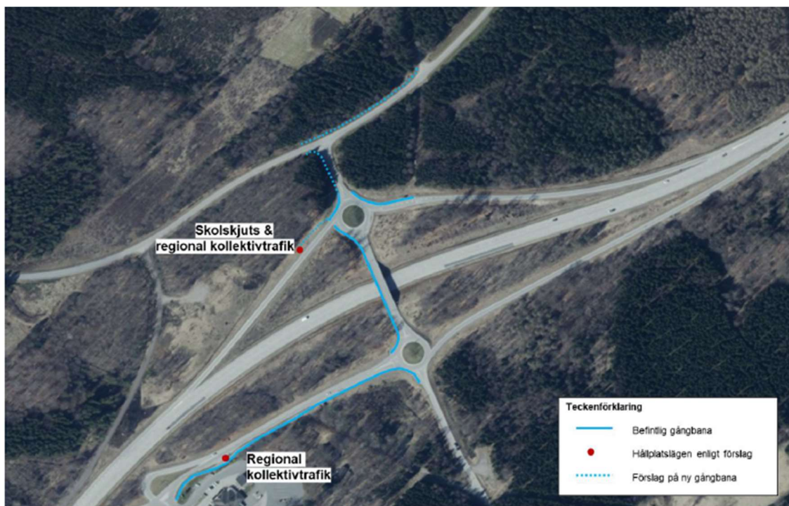
Figur 36. Befintliga gångvägar och förslag på ny gångväg i förhållande till förslag på nytt hållplatsläge. (Karta: Lantmäteriet, bearbetningar WSP)
