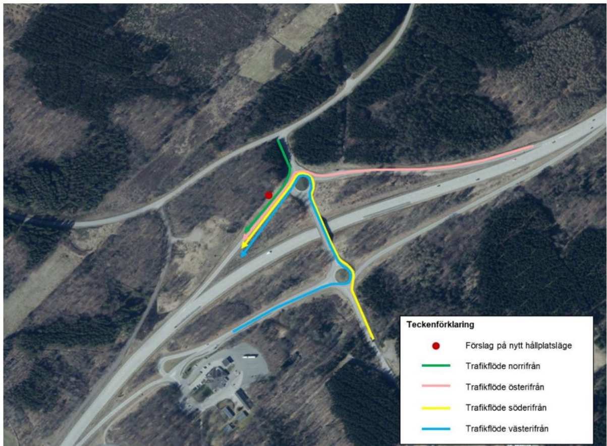
Figuren visar förslag på nytt hållplatsläge för regionbusslinje och skolbuss vid trafikplats Ekeröd och hur hållplatsen kan nyttjas av bussar oavsett vilket håll de kommer från. Hämtad från trafikutredningen (WSP, 2024).
