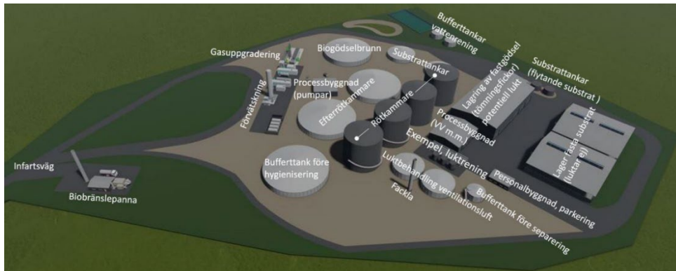
Exempel på layout för en biogasanläggning.
