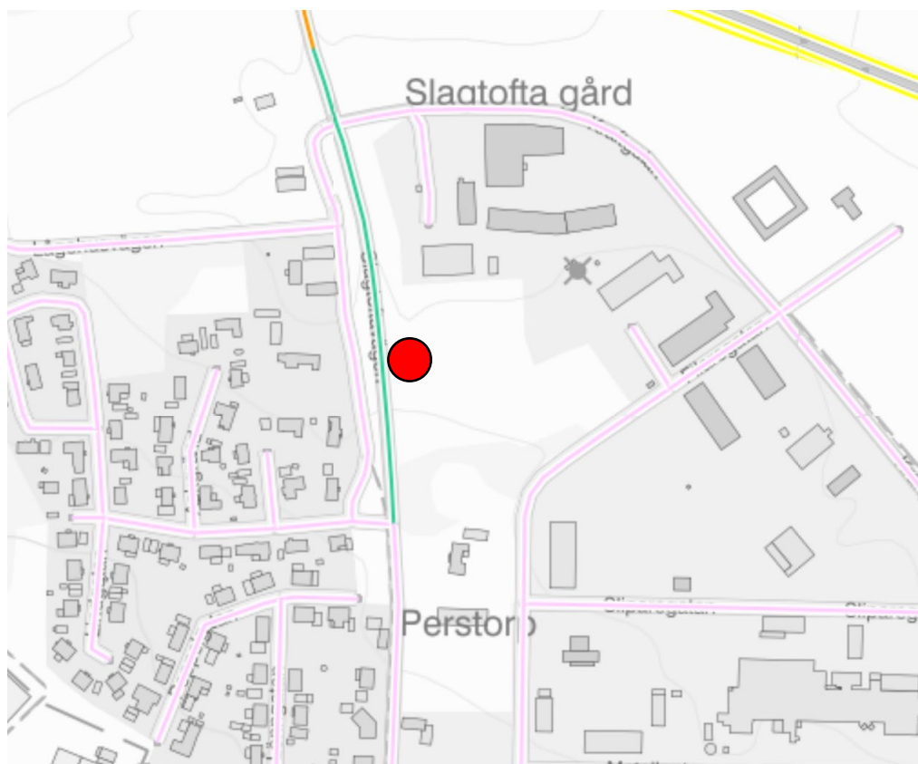
Bild över hastighetsbegränsning invid planområdet (röd punkt). Grönt streck motsvarar 60 km/h och rosa streck motsvarar 40 km/h.
