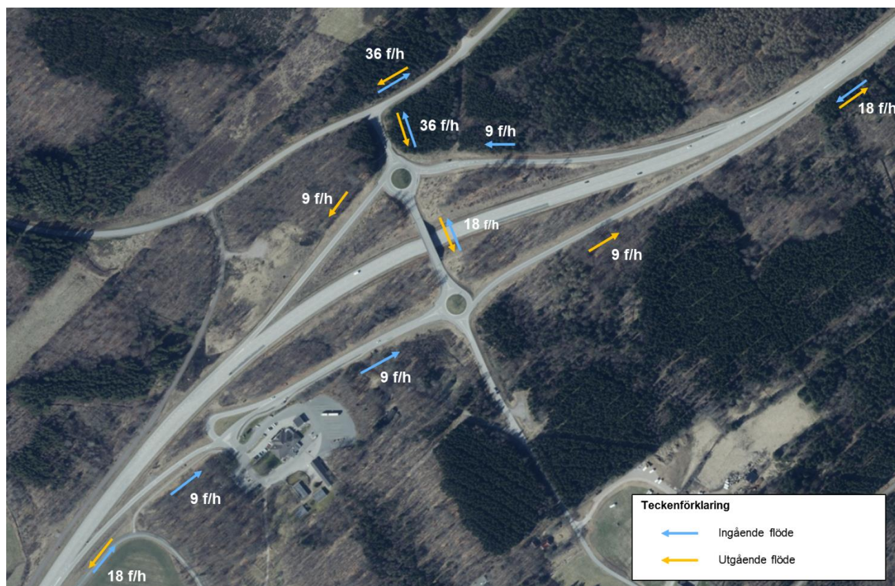
Figur 46. Fördelning av tillkommande in- och utgående godstrafikflöde (fordon per timme) till och från anläggningen under maxtimme. (Källa: Lantmäteriet, bearbetningar WSP)
