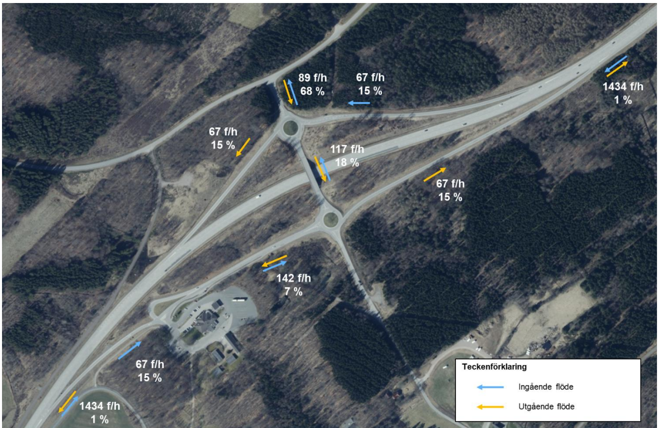
Figur 48. Trafikflöden under maxtimme för uppräknade trafikflöden för prognosår 2040, med etablering av biogasanläggning, samt procentuell andel transporter till och från anläggningen. (Karta: Lantmäteriet, bearbetningar WSP)
