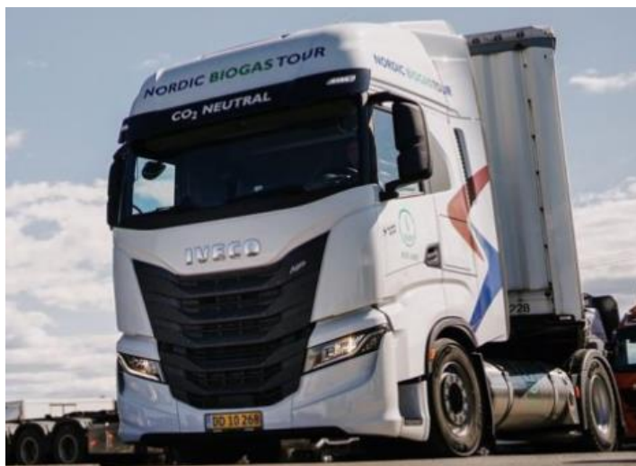
Figur 59: Ivecos trailerdragare som gjort långdistanstestet på LBG (källa: Trailer 2022-07-01)
