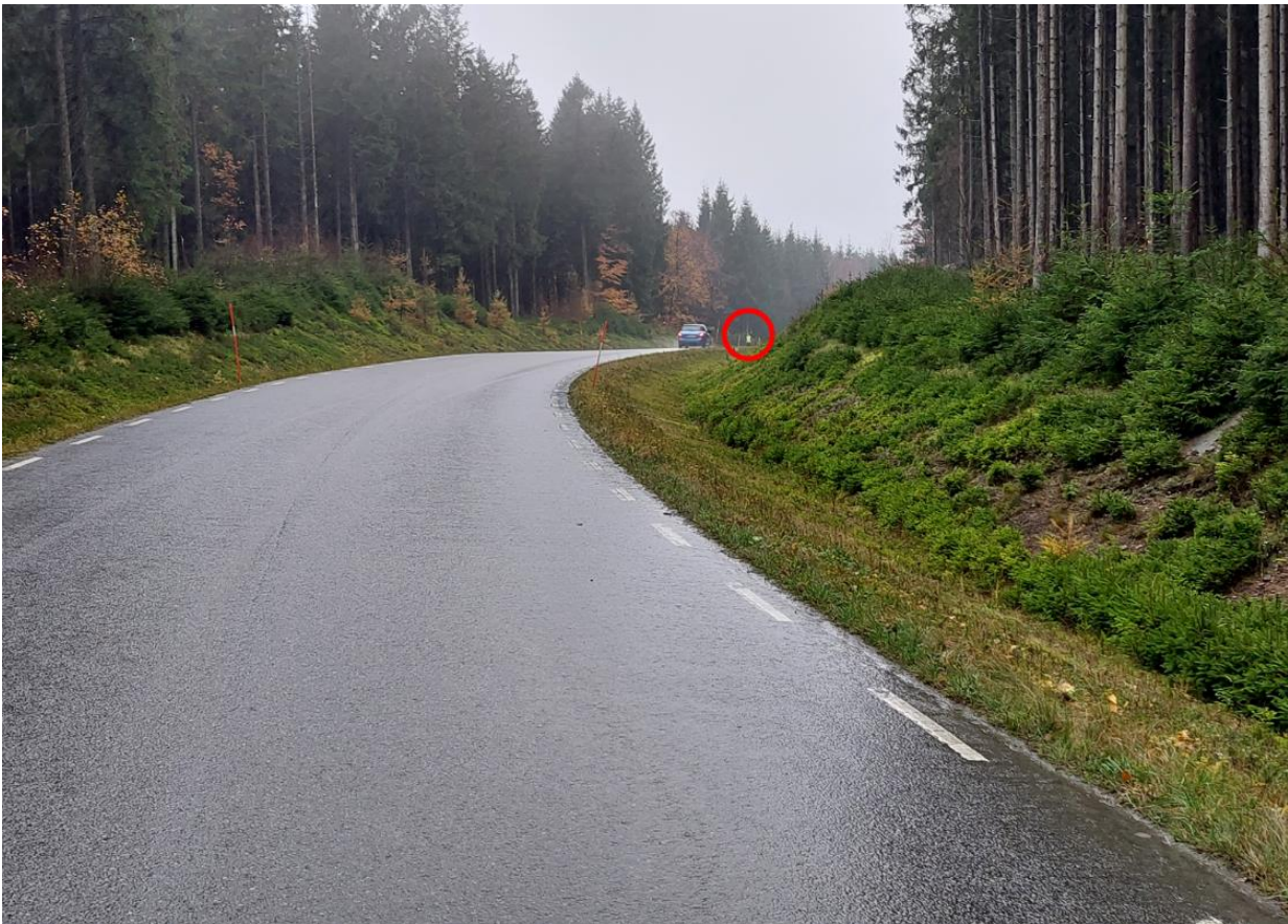
Figur 26. Sikt österifrån längs Väg 1343. Sikt delvis skymd för att uppnå 170 meter fri sikt. (Foto: WSP 2023)
